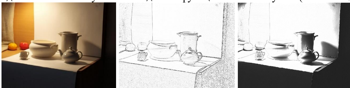
Рис. 1. Исходное изображение (слева); преобразование исходного изображения с помощью команды contrast для значения 45 (в центре); преобразование исходного изображения с помощью команд contrast и shadow =0,4 (справа). Преобразования выполнены в пакете R Sketcher.
